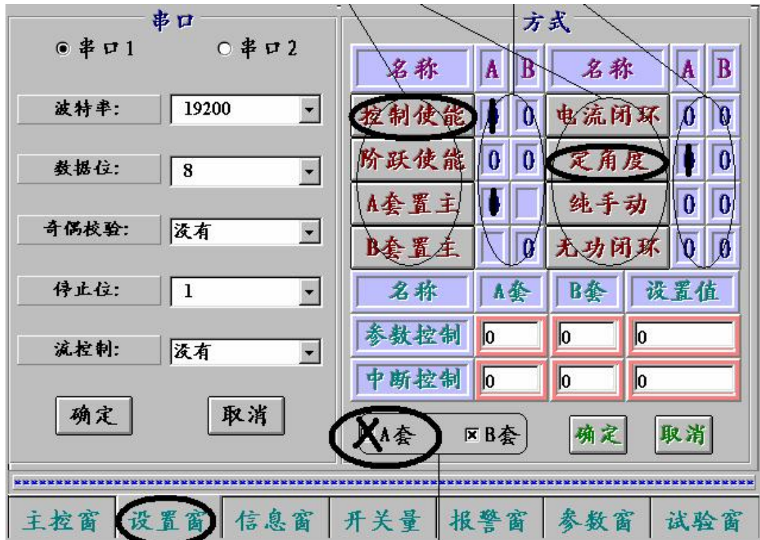
图5 励磁调节器开环测试设置画面
